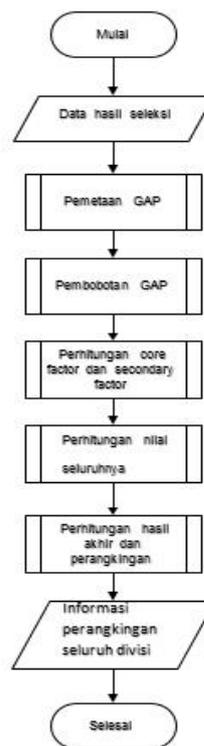
**Gambar 2.** Flowchart Sistem Pendukung Keputusan dengan Metode *Profile Matching*
